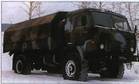
Серийное производство армейских автомобилей «КамАЗ» освоено в 1980 году. Первой моделью для Вооруженных Сил был многоцелевой «КамАЗ-4310» грузоподъемностью 6 тонн, предназначенный для монтажа вооружения и военной техники, буксировки прицепных артиллерийских систем и транспортных прицепов полной массой до 7 тонн, а также для перевозки войск и воинских грузов по всем видам дорог и местности.
