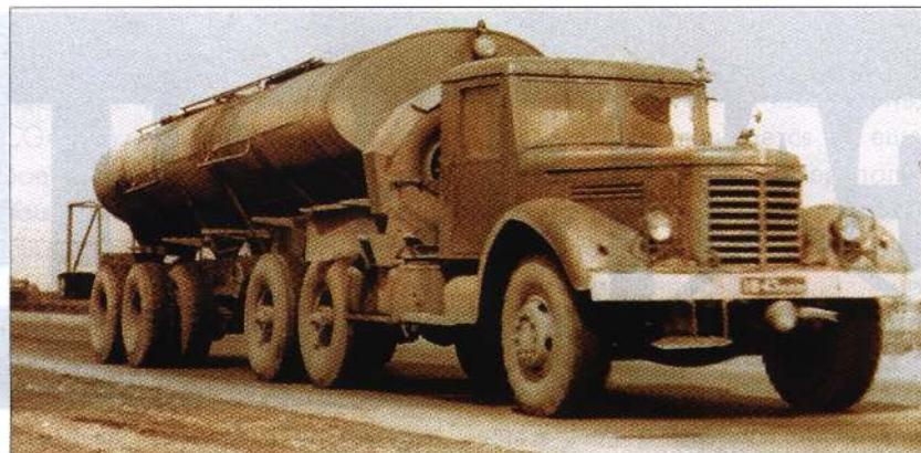
Седельный тягач ЯАЗ-210Д с полуприцепом-гудронатором «Д-375» на только что построенной МКАД, 1963 г.
